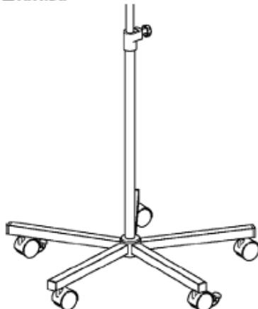
Бесступенчатая установка высоты и необходимого положения осуществляется одной рукой. При ослаблении винта устанавливается высота. Пока ослаблен винт, телескопическую трубку можно поднять или опустить.
